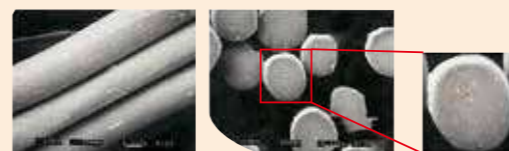
ポリエステル繊維に光電子®セラミックスを練り込んだ顕微鏡写真
